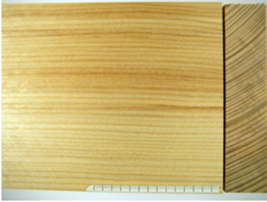
Bild 4.8 Rotstreifigkeit; Verfärbungen auf Längs- und Querschnitt
