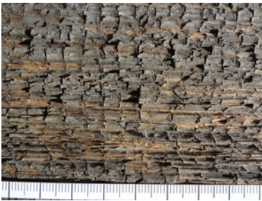
Bild 4.9 Moderfäule; sehr kleiner, schollenartiger Würfelbruch
