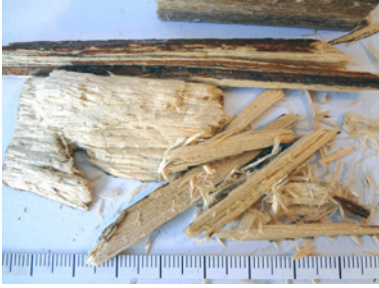
Bild 4.4 Weißfäule mit faserartiger Zersetzung des Holzes
