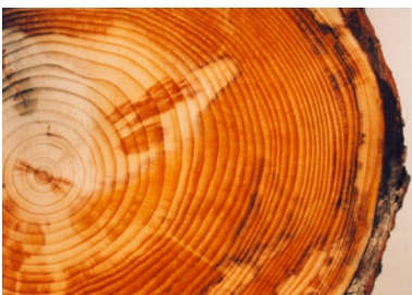
Bild 4.7 Rotfäule an einem Fichtenholzstamm
