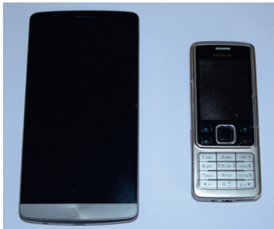
Bild 4.14 Fugen an Mobiltelefonen
