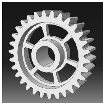
Bild 13.26-1: Geometrie des Zahnrades in ABAQUS
