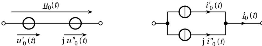
**Bild 2.4** Die systemtheoretische Realisierung komplexer Quellen erfolgt durch Reihen- bzw. Parallelschaltung reeller Quellen. In realen Systemen ist das jedoch nicht möglich.
