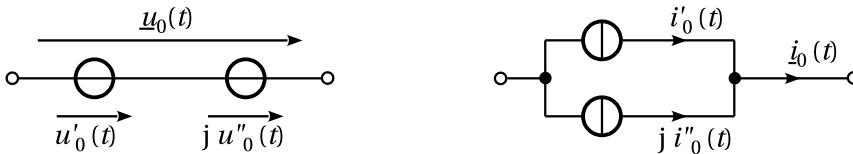
Bild 2.4 Die systemtheoretische Realisierung komplexer Quellen erfolgt durch Reihen- bzw. Parallelschaltung reeller Quellen. In realen Systemen ist das jedoch nicht möglich.
