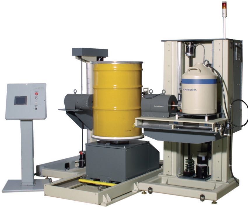
Bild 12.39 Tomografischer Gamma-Scanner (WM2900 TGS, mit freundlicher Genehmigung von Mirion Technologies (Canberra) GmbH)
