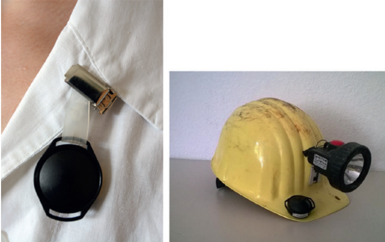
Bild 8.30 Radonexposimeter, Typ Altrac B97 (Bildquelle: LPS-Personendosismessstelle/ALTRAC Radon-Prüflabor)
